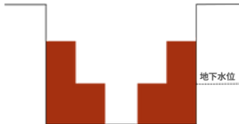
地下水の流入を抑制しながら施工する方法
